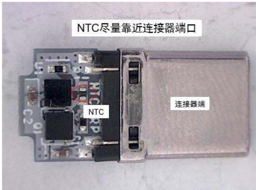
数据线在充电过程中，数据线和移动设备接触的连接端口内极易出现过热情况，所以为了提高感温 IC 的灵敏度，NTC 作为感温元件需要尽量靠近发热源，也就是尽量靠近连接器端。
