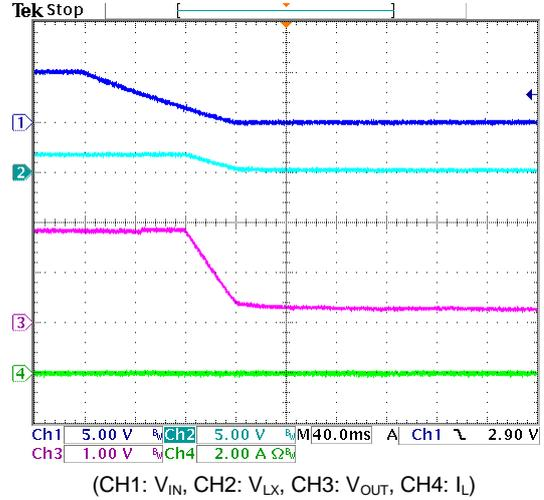
Fig. 9 V<sub>IN</sub> Power Off (V<sub>IN</sub>=5V, V<sub>OUT</sub>=1.8V, I<sub>OUT</sub>=0A)
