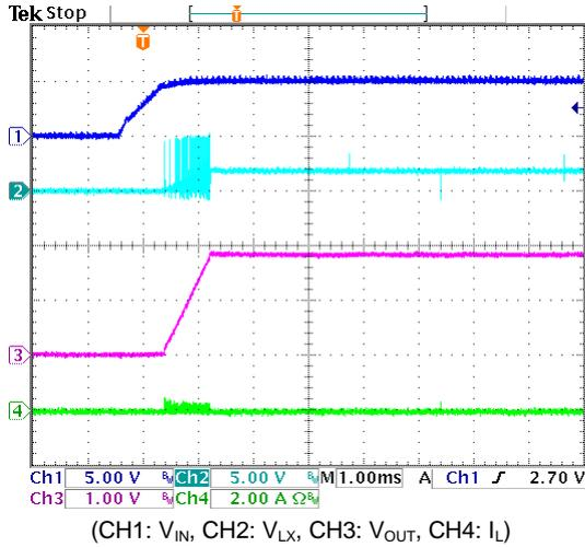
Fig. 8 V<sub>IN</sub> Power On (V<sub>IN</sub>=5V, V<sub>OUT</sub>=1.8V, I<sub>OUT</sub>=0A)
